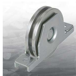
RUOTA 2 CUSCINETTI - L. TUBO MIN. 50 GOLA "Y" BI431 Ø120-140-160 GOLA "O" BI405 Ø120-140-160 GOLA "H" BI433 Ø120-140-160
